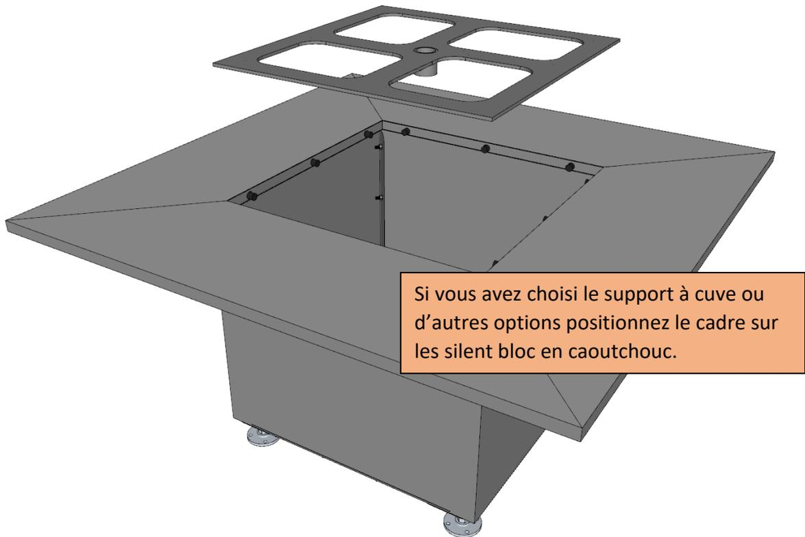
Si vous avez choisi le support à cuve ou d'autres options positionnez le cadre sur les silent bloc en caoutchouc.
